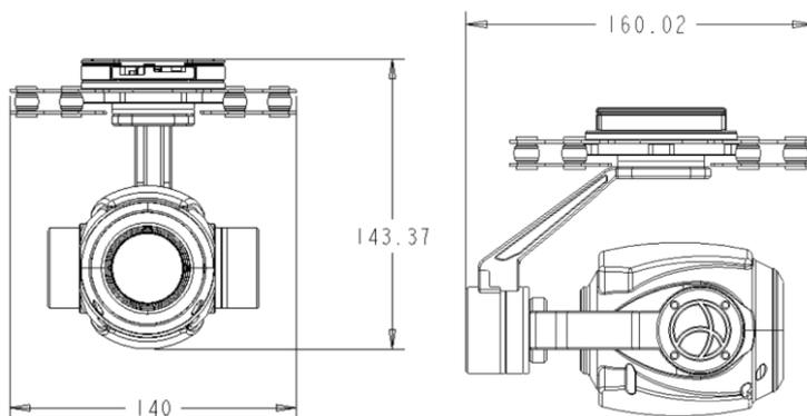
减震板安装孔间距 100mm\*100mm; 安装孔大小: 4\*M2.5
