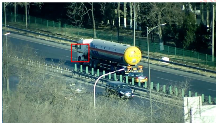
图 3 使能跟踪，选中框变为红色即可跟随物体，一旦跟踪目标丢失，选中框会重新变成蓝色，停止跟踪
