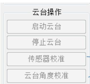
当云台角度不水平或者发现云台在静止情况下陀螺仪的输出离零值较远时，请校准传感器及云台角度。
