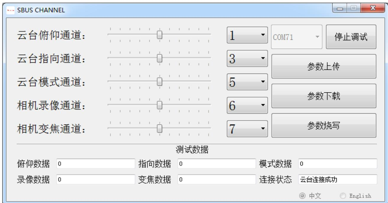
④将 SBUS 解码模块与遥控器接收机的 SBUS 接口相连,设置遥控器里面对应功能通道的映射关系。在不同档位,请使用遥控器中的舵机行程调整功能 ( 如 Futaba 产品的 Endpoint 功能 ) 进行调整。
